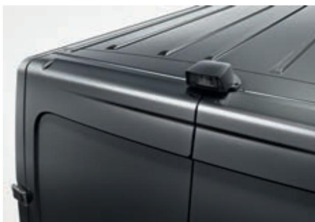
**3** RETROVISIONE CONTINUA con una telecamera posta sul retro del tetto per monitorare il traffico stradale posteriore.
